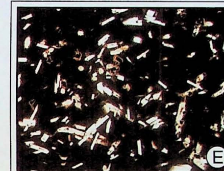
Lâmina petrográfica - amostra GX-131B: Em afloramento observa-se rocha vítrea (obsidiana) de coloração preta, maciça, afanítica a fanerítica muito fina. Em microscópico petrográfico nota-se matriz vítrea de coloração preta, pouco oxidada, e textura equigranular (cristais euédricos a subédricos de plagioclásio, piroxênio e opacos). Lado maior da foto: 3,25 mm.
