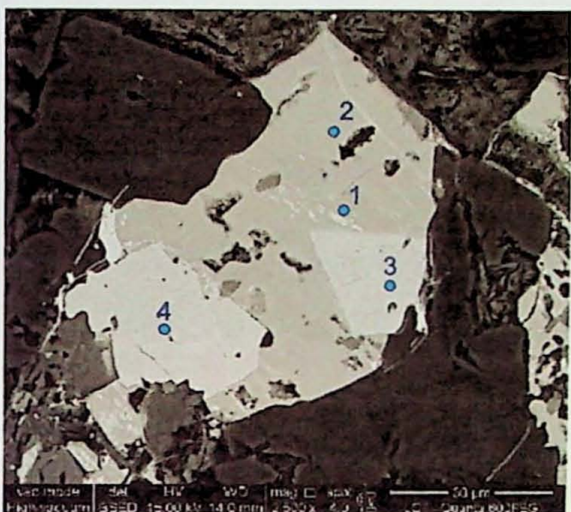
Imagem 03: Cristais subédricos a anédricos de Ti-magnetita (nomenclatura cA, pA)
