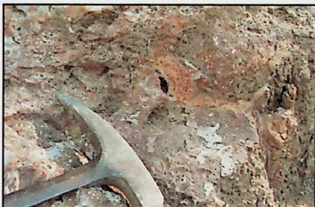
Foto 03: Fácies vesiculada. Rocha afanítica maciça, de coloração avermelhada, intensamente vesiculada - vesículas milimétricas a centimétricas, arredondadas, comumente preenchidas por calcedônia e calcita.
